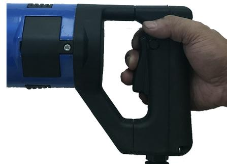
Если сверление выполняется на станине, черную клавишу включения питания можно зафиксировать в нажатом положении. Для этого при нажатой клавише необходимо нажать блокиратор большим пальцем.
