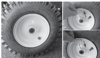
Рис.17 Установка шплинта на левом колесе
