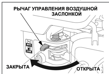
Рис. 15 Рычаг управления воздушной заслонкой PC6337F
