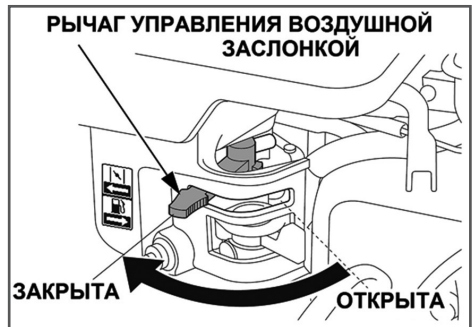
Рис. 11 Воздушная заслонка закрыта
