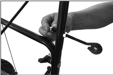
Рис. 13 Монтаж кронштейна рычага поворота желоба
