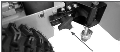
Рис. 7 Отсоединение щетки от корпуса машины
