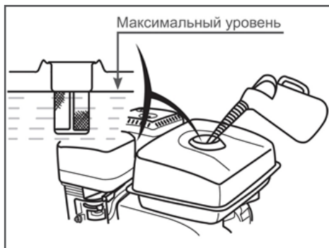
Рис. 7 Максимальный уровень топлива в топливном баке
