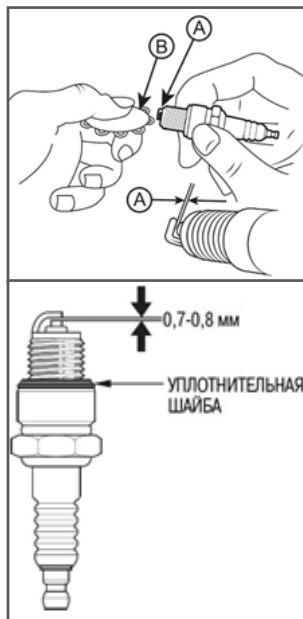
Рис. 23 Зазор между электродами свечи зажигания
