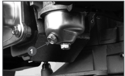
Рис. 20 Слив топлива с поплавковой камеры карбюратора
