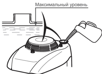
Рис. 14 Максимальный уровень топлива в топливном баке
