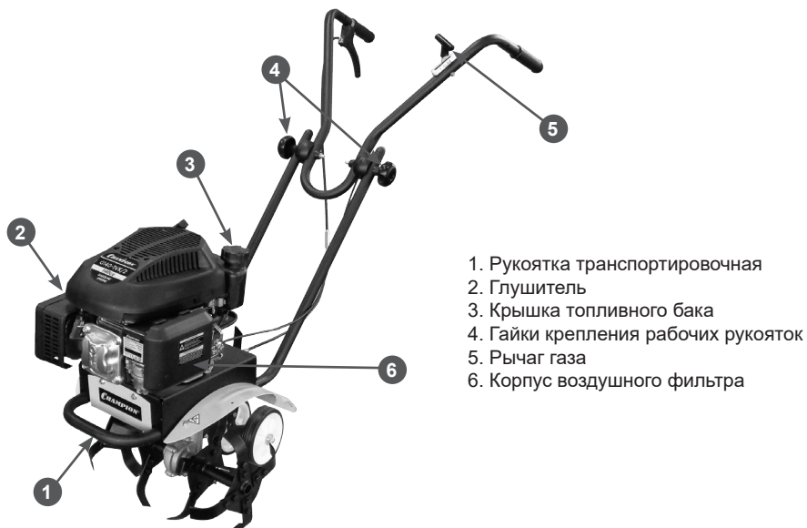
Рис. 2 Основные узлы и органы управления
