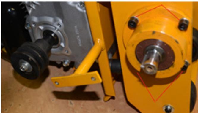
Вытащить вал из подшипника, который остался установленным, при необходимости выдавить его с помощью болта:
