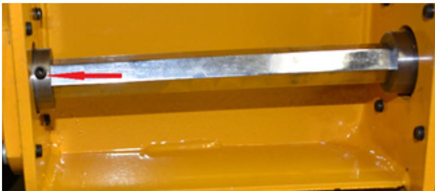
Снять шкив привода барабана и обойму подшипника, открутив 4 болта:
