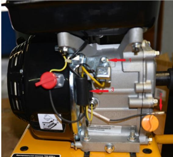
Рис. 1. Места подключения проводов.
