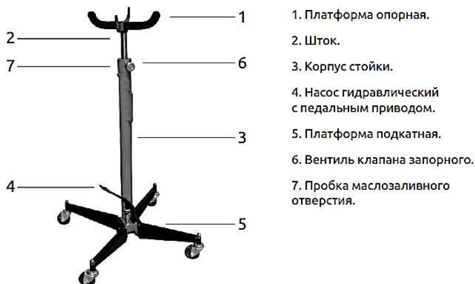
Устройство трансмиссионной стойки
