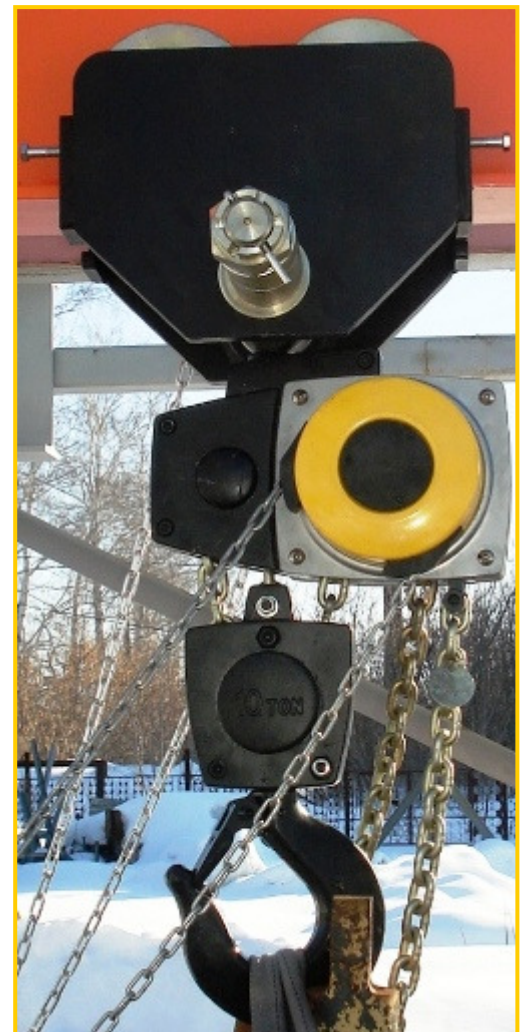
Таль передвижная ТРШБМ-10,0 грузоподъемностью 10 тонн
