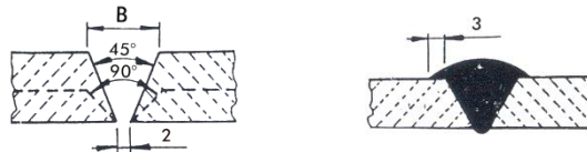
Giunto da saldare preparato
