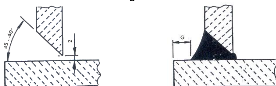
Giunto da saldare preparato
