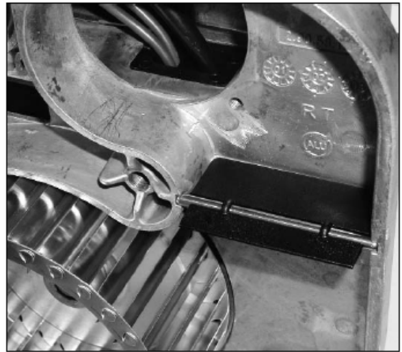
Рисунок 28 – Место установки воздушной заслонки
